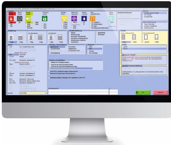
Bild 5: Mit dem Schörghuber-Ausschreibungs- und Kalkulationsprogramm „FormCalc“ lassen sich barrierefreie Türelemente schnell und einfach konfigurieren.
