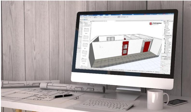
**Bild 2:** Schörghuber kommt der Verantwortung als führender Türhersteller nach und stellt Architekten erste BIM-Daten bereit. Ein mit BIM-Daten geplantes Bauvorhaben umfasst alle relevanten Informationen zur Planung, Ausführung und Infrastruktur und soll allen am Bau Beteiligten einen direkten und stets aktuellen Planungsstand bieten. Grundvoraussetzung dabei ist eine BIM-konforme Informationsgrundlage.
