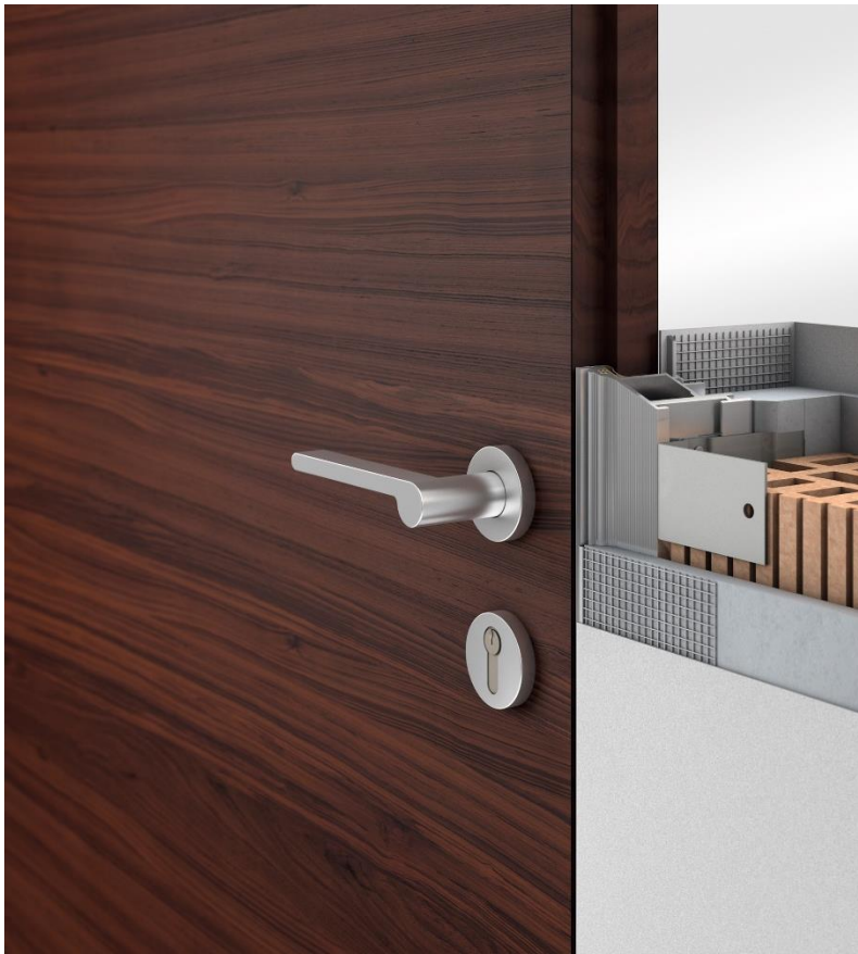
Bild 5: Das Aluminiumprofil der Schörghuber Zeroline Zargen wird nach der Montage vollständig verspachtelt, verputzt oder verkleidet. Ein einklickbares Putznetz sorgt dabei für einen fließenden Übergang und verhindert die Bildung von Haarrissen zwischen Zarge und Wand.
