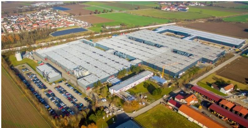
**Bild 2:** Beim Bau der Halle 4 am Schörghuber Firmensitz in Ampfing wurden zahlreiche Maßnahmen zur Energieeinsparung realisiert. Dazu zählen unter anderem eine Hallenbeleuchtung mit LED, eine hochwertigere Wärmedämmung und eine Filteranlage mit Wärmerückgewinnungsfunktion.
