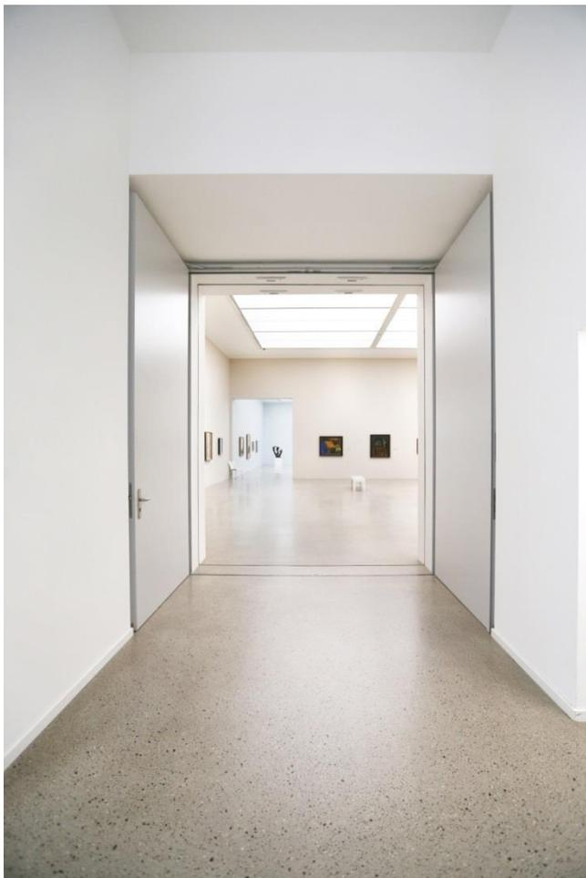
**Bild 14:** Eingangssituation des Ausstellungsbereichs im Neubau. Die raumhohe Schörghuber Nischentür schließt im Brandfall automatisch und trennt die Gebäudeteile vonei-
