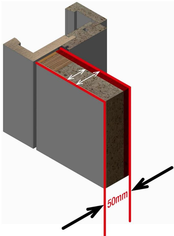
**Bild 2:** Die Umstellung der Türblattstärke von 42 mm auf 50 mm erhöht nicht nur die Qualität der Schörghuber Türen und die Sicherheit im Brandfall, sondern ermöglicht Architekten und Planern auch erweiterte Ausstattungs- und Gestaltungsmöglichkeiten.
