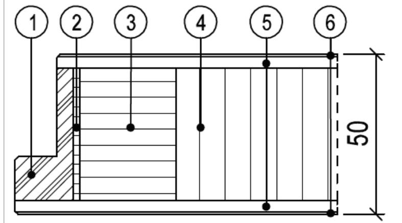
**Bild 3:** Durch das serienmäßig 50 mm starke Türblatt und einen mehrfach vollflächig verleimten Türblattaufbau, bestehend aus Mittellage (4), Schichtholzrahmen (3), Anleimer (1), Decklage (5), Oberfläche (6) und bei Brandschutz Türen einem Dämmschichtbildner (2), erreichen alle Schörghuber Türen standardmäßig die Beanspruchungsklasse 4 („E“ extrem).
