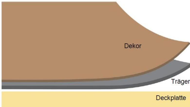
**Bild 3:** Die besonders widerstandsfähigen Eigenschaften der Durat Oberfläche basieren auf einem speziellen Herstellverfahren auf Melaminharzbasis, bei dem Dekor, Träger und Deckplatte in nur einem Arbeitsgang unter hohem Druck unlöslich miteinander verpresst werden. Auf Leim kann bei diesem Verfahren aus eigener Produktion und Entwicklung verzichtet werden.
