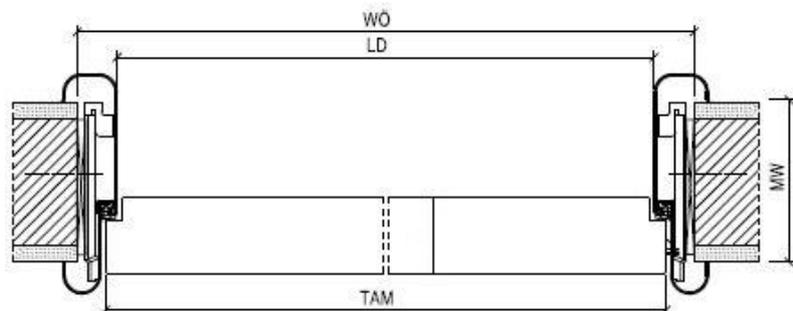
**Bild 2 und Zeichnung:** Die Stahlrundformzarge wurde so konzipiert, dass sie keine Ecken und Kanten aufweist und sich das Türblatt so eng um die Zarge dreht, dass praktisch kein Verletzungsrisiko besteht.
