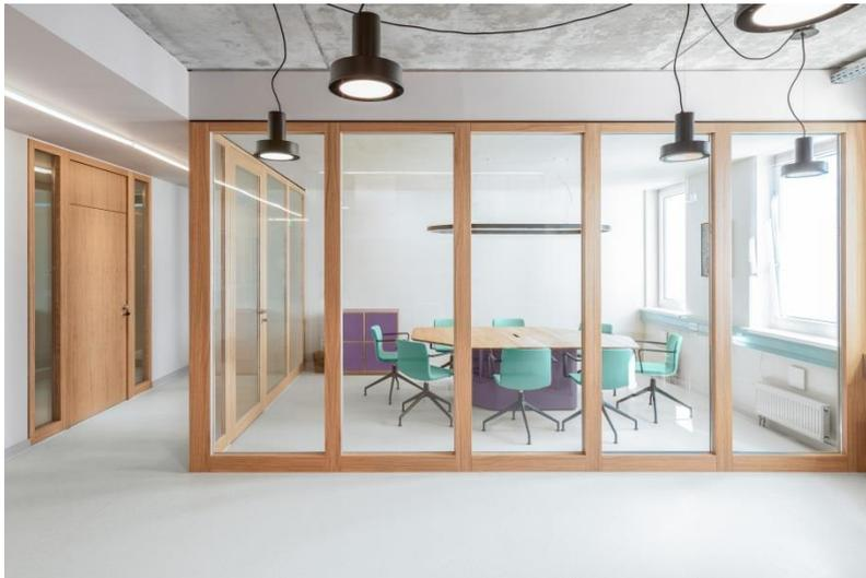
**Bild 2:** Hochschalldämmende Festverglasungen von Schörghuber eignen sich ideal als Raumteiler, die sowohl fließende visuelle Raumübergänge schaffen als auch hohe Schallschutzwerte von bis zu 50 dB erreichen. Bei Bedarf ist auch eine F30 Brandschutzfunktion mit Prüfzeugnis möglich.
