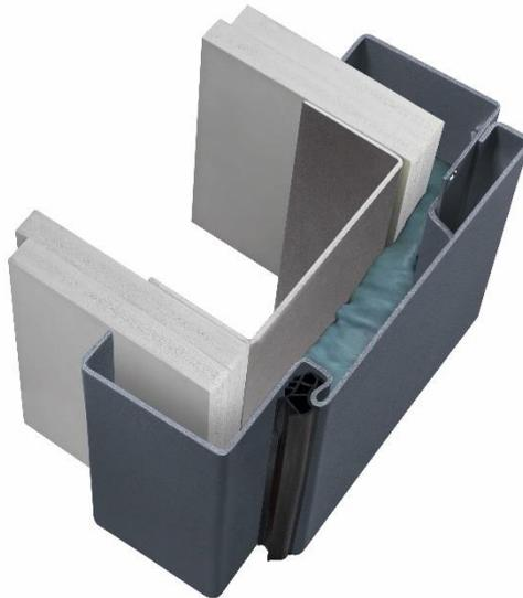
**Bild 2:** Der Zierfalz der Stahlumfassungszarge VarioFix von Schörghuber ist verstellbar. Damit können Wandtoleranzen bis 20 mm (- 5/+15 mm) ausgeglichen werden.
